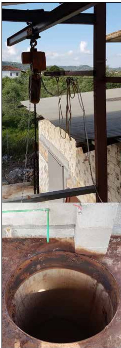
Med hjälp av en vinsch sänks briar-klossarna ner i hålet i golvet för att kokas i minst 16 timmar.
